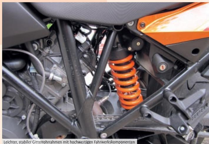
Leichter, stabiler Gitterrohrrahmen mit hochwertigen Fahrwerkskomponenten
