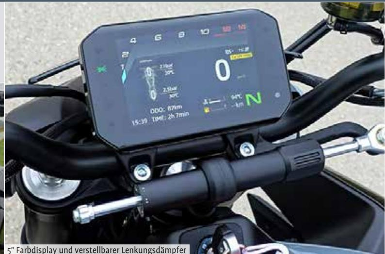
5" Farbdisplay und verstellbarer Lenkungsämpfer
