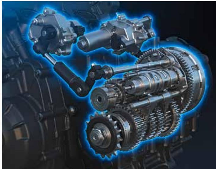
kann auch das mit dem Wippschalter umgangen werden. Die Y-AMT verfügt über den weichen „D“-Modus und den dynamischeren „D+“-Modus. Zusätzlich erhält die neue Ausführung ein Smart-Key-System.
