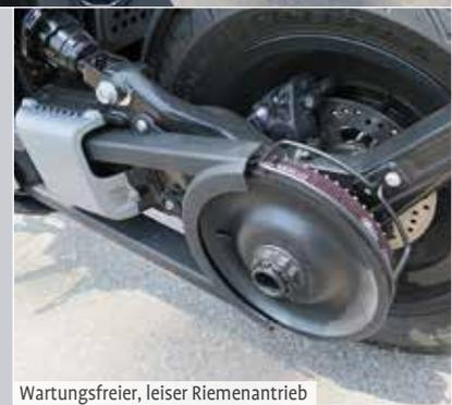
Wartungsfreier, leiser Riemenantrieb
