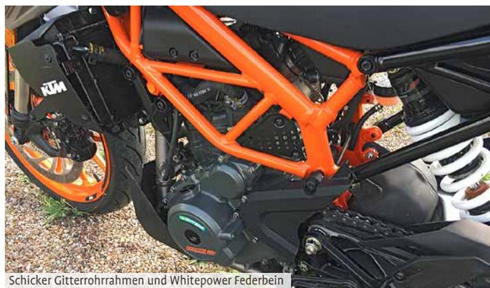
Schicker Gitterrohrrahmen und Whitepower Federbein
