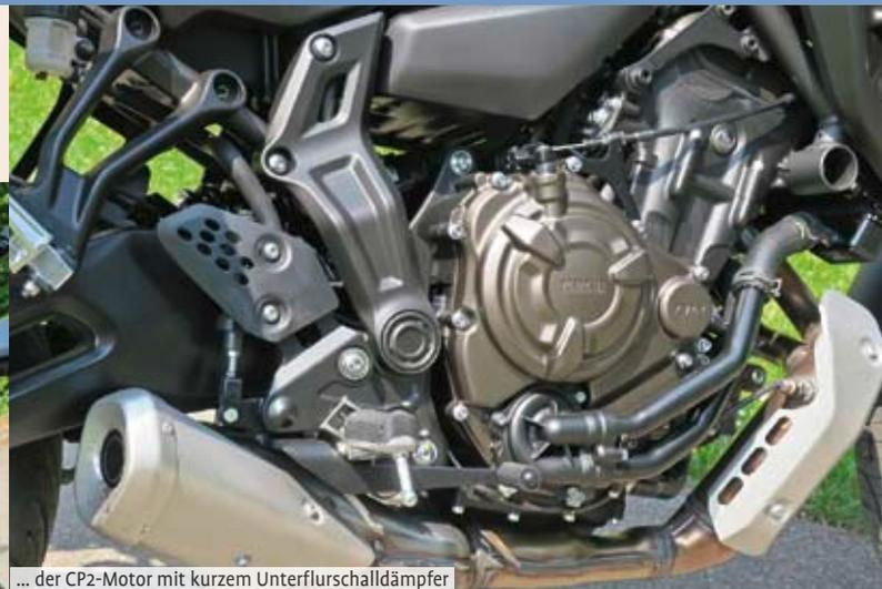
... der CP2-Motor mit kurzem Unterflurschalldämpfer
