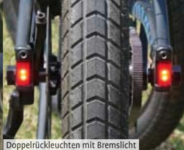
Doppelrückleuchten mit Bremslicht
