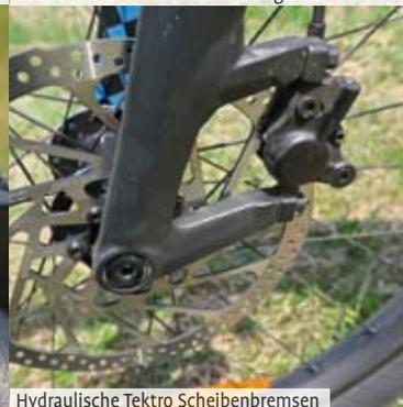
Hydraulische Tektro Scheibenbremsen
