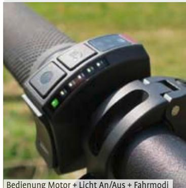
Bedienung Motor + Licht An/Aus + Fahrmodi
