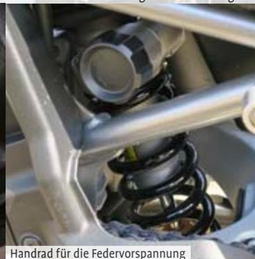
Handrad für die Federvorspannung
