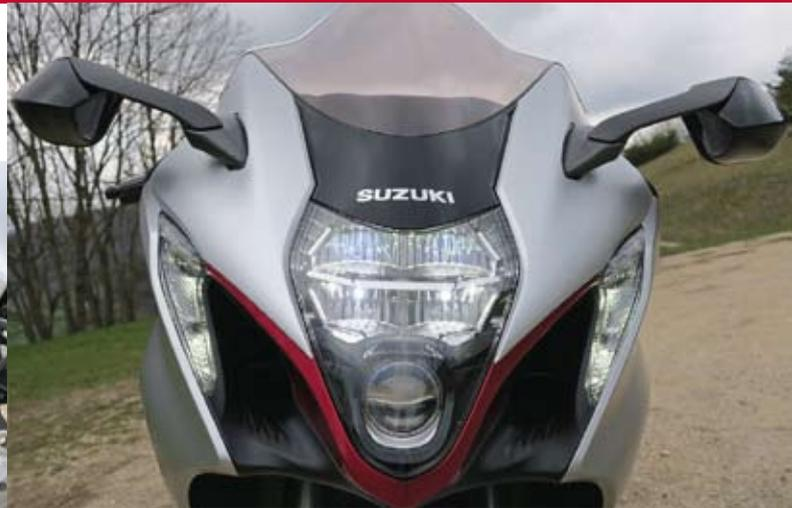
Neue Front, komplett mit LED-Beleuchtung, integrierten Blinkern und Insektenspiegeln
