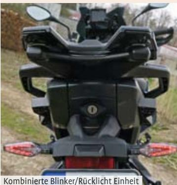
Kombinierte Blinker/Rücklicht Einheit
