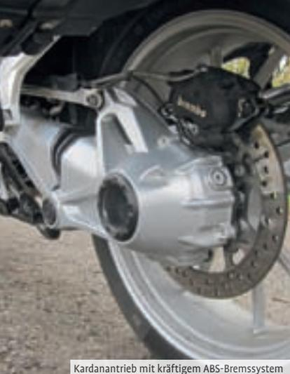
Kardantrieb mit kräftigem ABS-Bremssystem
